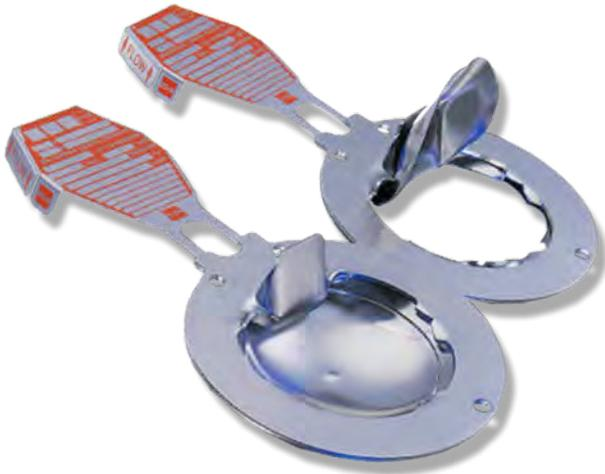
Bei Erreichen des Ansprechdrucks kehrt sich die Sigma EXL Berstscheibe um und reißt entlang einer radialen Vorkerbung nahe des Umfangs der Kuppel auf. Die Vorkerbung endet in einer integrierten auslassseitigen Schamereinheit, die das Öffnen der Scheibe entlang der Vorkerbung unterstützt und so Fragmentation verhindert. Die Sigma EXL wird mit einer einfachen Berstdrucktoleranz angeboten.
