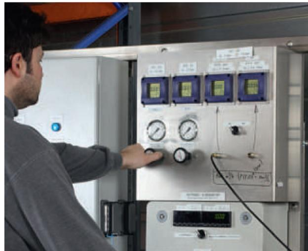
Sämtliche Druckregler werden auf unserem Prüfstand auf Funktion getestet und auf die Prozessdaten eingestellt. Vor dieser Funktionskontrolle werden die Druckregler auf Dichtheit nach aussen geprüft. Für jeden produzierten Regler werden die Leistungsdaten und die Reglercharakteristik erfasst.
